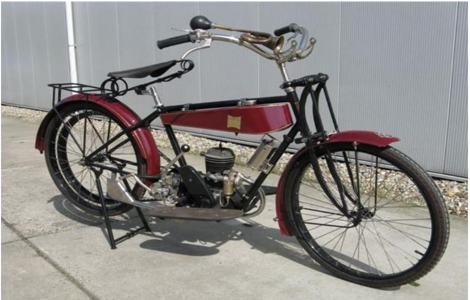
De Rhône van Jan Petter, 170 cc tweetakt, riemaandrijving, Albion bak met twee versnelingen
